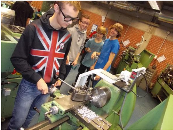
Plan drehen einer Seite mit der Drehmaschine
