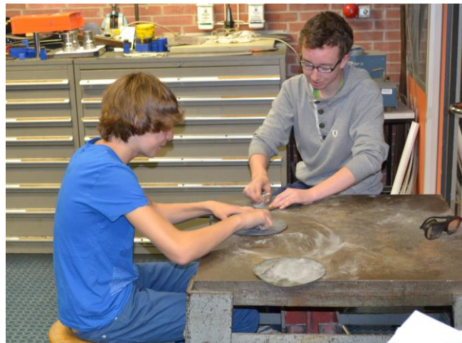
Riefen aus der Bearbeitung mussten mühsam ausgeschliffen werden
